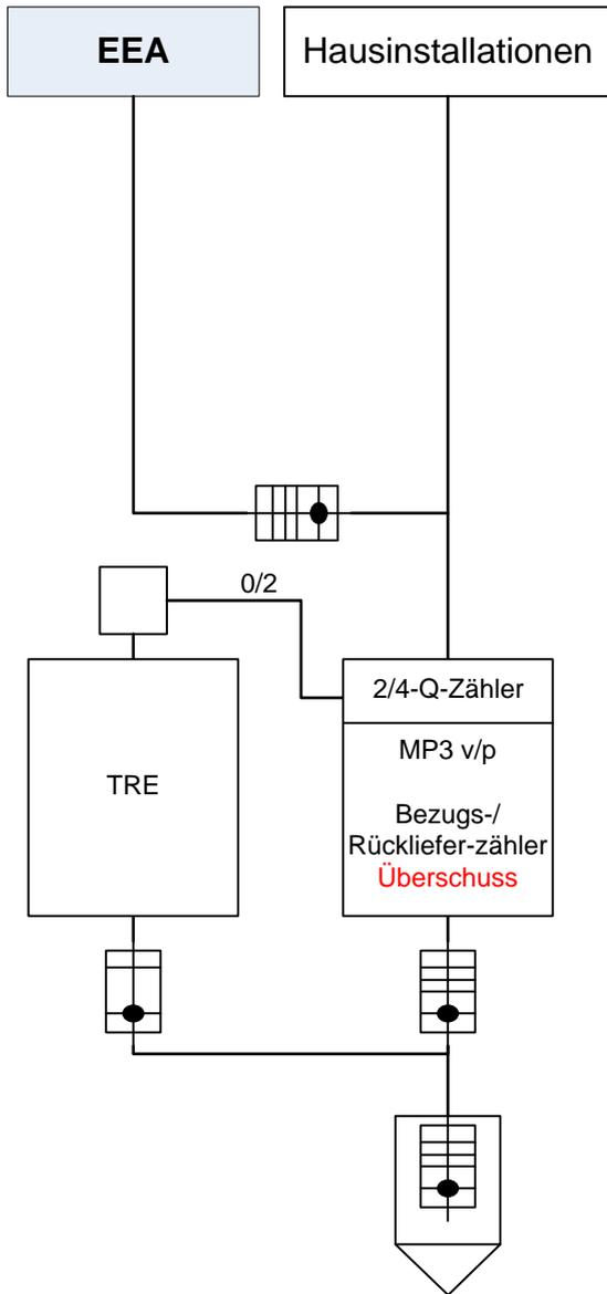
Zähler mit vorgeschalteten Überstromunterbrechern > 80 A, beziehungsweise Zählerverdrahtungen mit einem Querschnitt > 25 mm<sup>2</sup>, werden über **Stromwandler** angeschlossen (separates Schema beachten).
