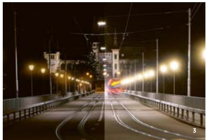
Bild 1: Die Optik einer Leuchte bestimmt darüber, wie sie die Strasse ausleuchtet. Für breitere Strassen braucht es eine breit strahlende Optik und umgekehrt.
